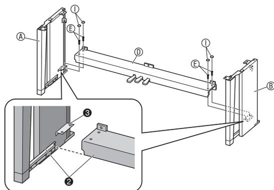
3. Faites glisser le panneau arrière ③ dans les rainures ④ des panneaux latéraux.
