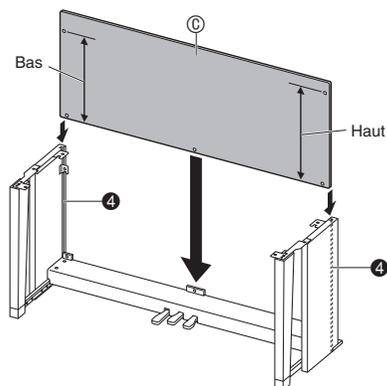
4. Fixez le côté gauche du panneau arrière ③ à la ferrure ⑤ du panneau latéral ①, et le côté droit au panneau latéral ②. Serrez partiellement les deux vis ⑥ pour maintenir en place temporairement le panneau arrière.
