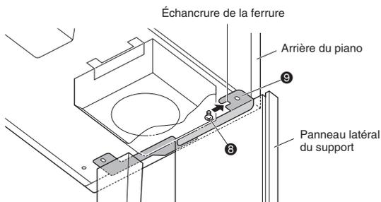
9. D'abord, utilisez les deux vis ① pour fixer l'arrière du piano (côtés gauche et droit) au support. Ensuite, utilisez les deux vis ② pour fixer l'avant du piano (côtés gauche et droit).
