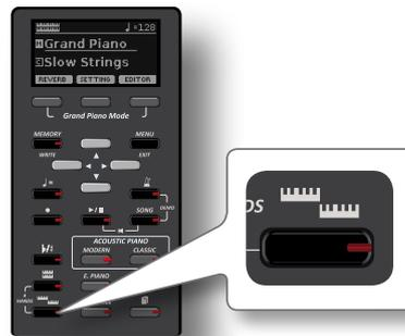
La clavier est divisé en deux parties. La zone du clavier située à gauche du point de partage devient la partie Lower, tandis que la zone du clavier située à droite du point de partage devient la partie Main.
