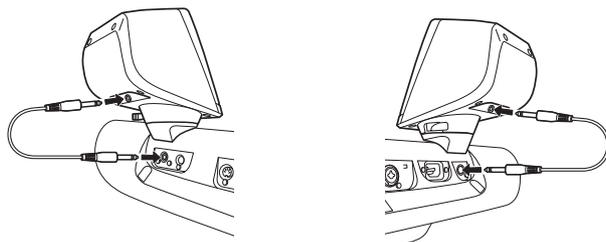
Les deux câbles peuvent être utilisés de manière interchangeable sur les deux prises de sortie.
