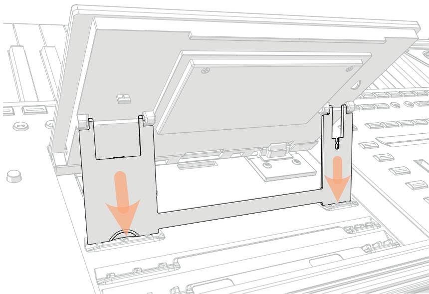
5 Rilasciare il pulsante **UNLOCK** per fissare il display alla posizione corrente.
