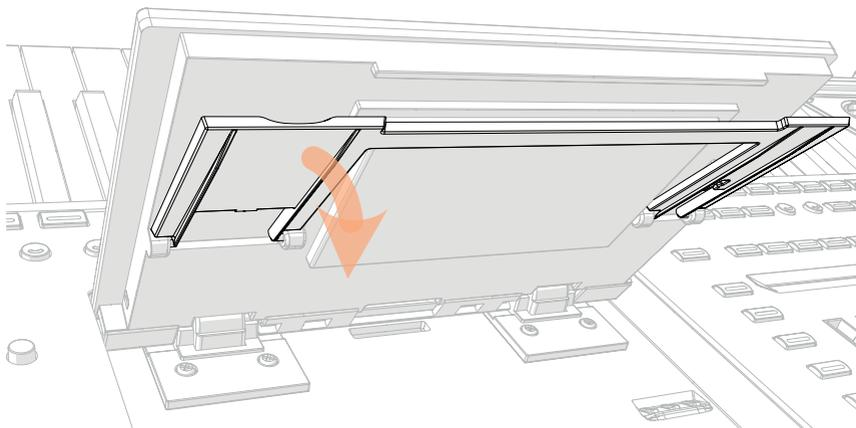
4 在保持 UNLOCK 按钮按下的同时, 调整倾斜角度并固定支架到显示器外壳底部的一个挡块。
