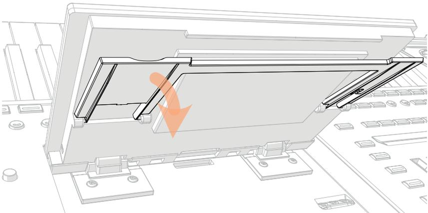
4 Mantenga pulsado el botón UNLOCK, ajuste el ángulo de inclinación y fije el soporte a uno de los topes en la parte inferior de la carcasa de la pantalla.
