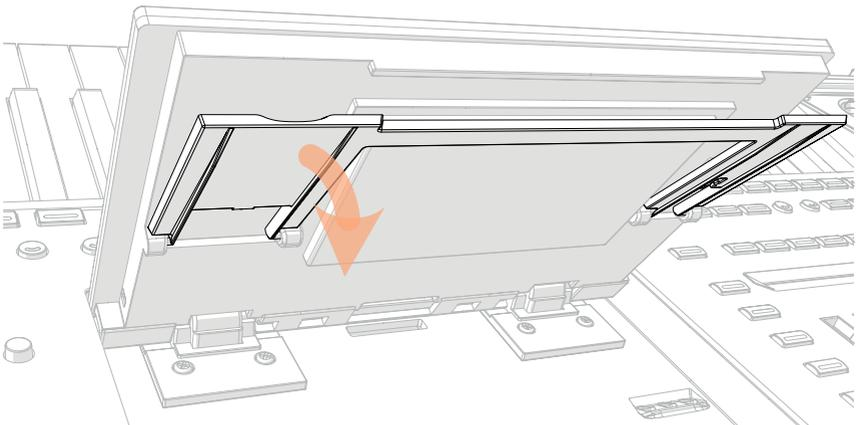
4 Tout en maintenant le bouton **UNLOCK** enfoncé, réglez l'inclinaison de l'écran et fixez la béquille dans l'une des séries d'encoches pratiquées dans le logement de l'écran.
