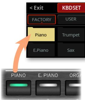
È sempre possibile uscire da questa finestra premendo il pulsante EXIT, oppure toccando il comando Exit che appare nell'angolo in alto a sinistra del display.
