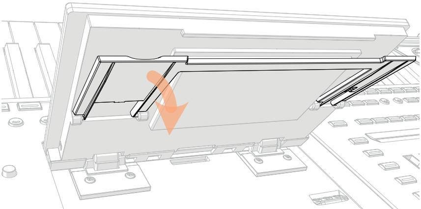
4 Halten Sie **UNLOCK** gedrückt, während Sie die gewünschte Neigung einstellen. Verankern Sie die Stütze in einer der Kerben innerhalb des Display-Fachs.
